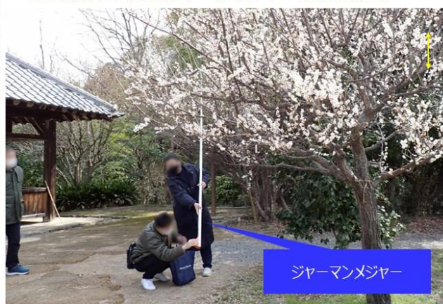
離れた位置から確認した後、下のゲージの読み取りを行う
